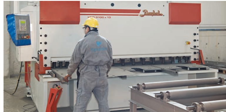
13 mm kalınlık ve 3000 mm genişliğe kadar sac kesme kapasitesi
