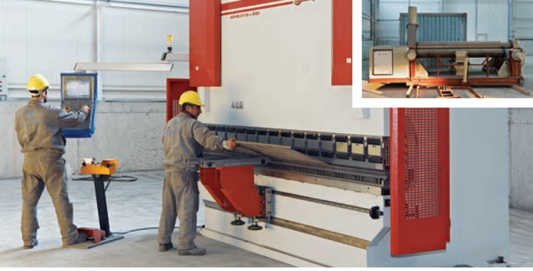
16 mm kalınlık ve 3.000 mm genişliğe kadar sac bükme kapasitesi, hidrolik silindir ile 25 mm'ye kadar sac bükebilme
