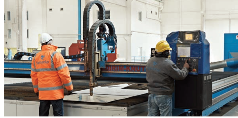
CNC plazma ile 60 mm, oksijenle 200 mm'ye kadar kesme kapasitesi
