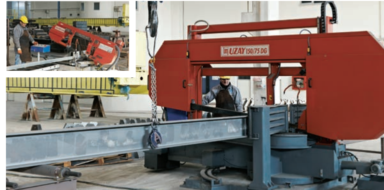
350 mm ve 1.500 mm'ye kadar profil kesme kapasitesi
