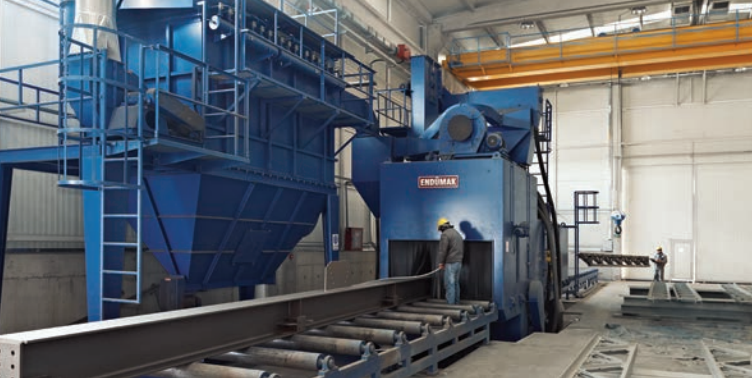
100 ton/gün'e kadar Sa 3 kalitesinde kumlama ve yüzey hazırlığı
