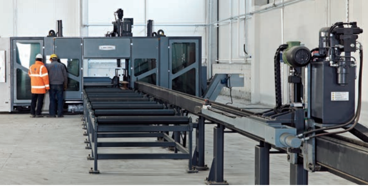
3 boyutlu, tam bilgisayar kontrollü (CNC) delme ve markalama
